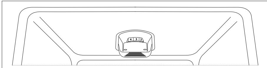
Термостат автоматически регулирует температуру внутри холодильной и морозильной камер. Путем изменения позиции ручки с MIN («1») на MAX («5») может быть достигнута более низкая температура
